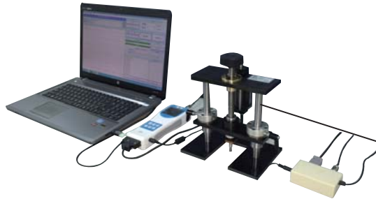
温度膨張率評価用荷重印加装置
