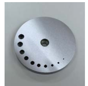
自立出来ないバネの測定用にホール付き圧縮盤も御座います。
